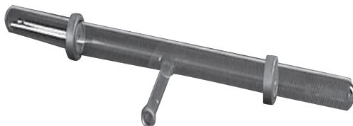
O tubo de descarga em gases serve para a observação das luminosidades emitidas nas descargas elétricas em gases rarefeitos, bem como para a análise de raios cátodos e canais que aparecem, sob pressão baixa, fora do curso de descarga.
