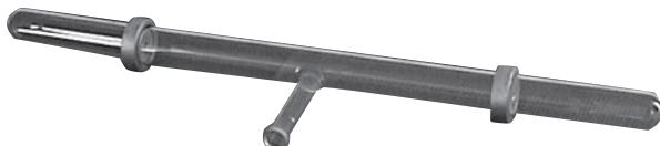
Il tubo di scarica serve per osservare la luminescenza in presenza di scariche elettriche in gas a pressione ridotta e per esaminare raggi catodici e positivi, che subentrano in presenza di bassa pressione al di fuori della distanza di scarica.
