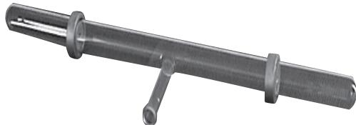
El tubo de descarga de gases se utiliza para la observación de fenómenos luminosos ante descarga de gases, con presión reducida, así como de los rayos catódicos y canales que, con baja presión, aparecen fuera del tramo de descarga.
