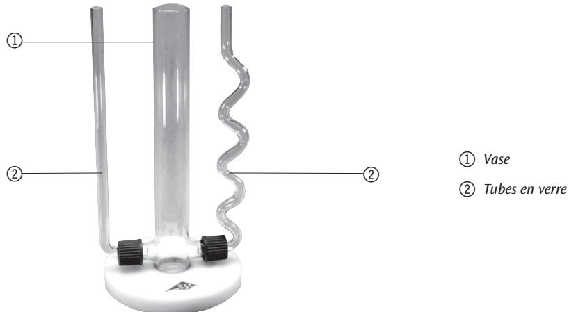
Le dispositif des vases communicants permet de démontrer le niveau d'eau dans des vases reliés entre eux.
