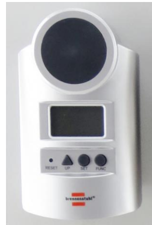
Fig. 6 Medidor de energia
